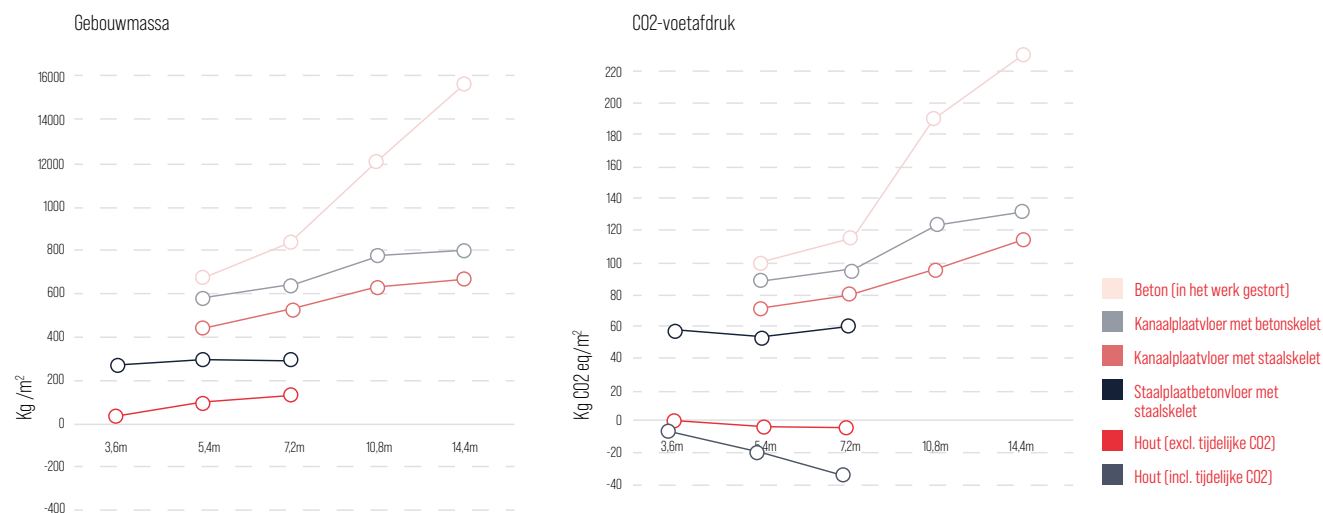
Figuur 3. CO 2 voetafdruk van dragende vloeren (kg Co 2 eq/m 2 )
